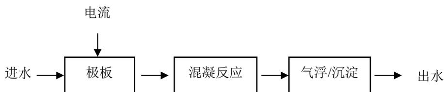
图3 电混凝工艺流程图
