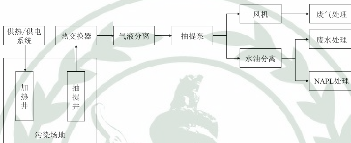
图 2 热强化多相抽提技术工艺流程图
