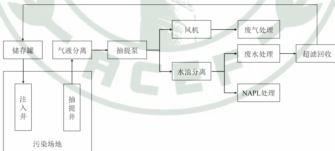
图 4 增溶强化多相抽提技术工艺流程图
